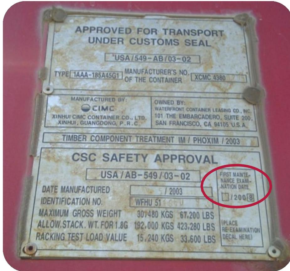
Esquema de Inspecciones Periódicas VENCIDO encontrado durante las inspecciones Mayo 2008
