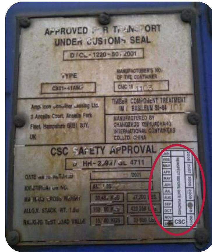
Esquema de Inspecciones Periódicas VIGENTE encontrado durante las inspecciones Diciembre 2010
